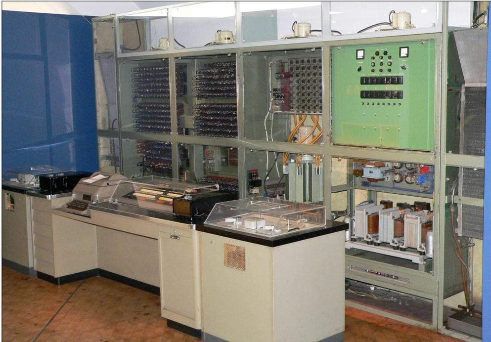
Abbildung 4-2: Rechner Zuse Z22. Im zweiten Schrank von rechts ist der Magnettrommel-Speicher mit Ansteuerungs-Elektronik zu erkennen. Neben und auf dem Bedienpult im Vordergrund sind mehrere Peripheriegeräte aufgestellt (Technik-Museum Berlin).
