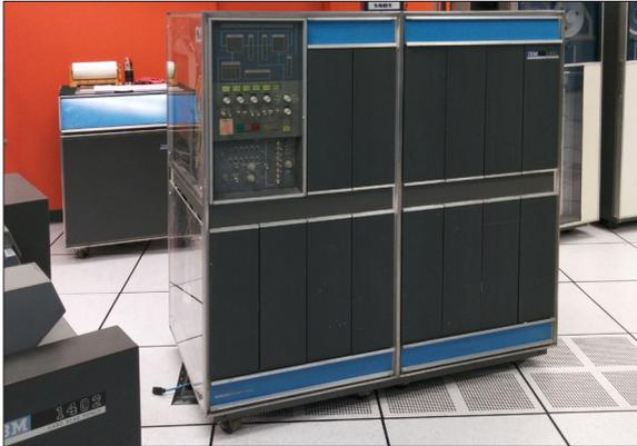
Abbildung 3-1: Die Zentraleinheit des Rechners IBM 1401 kombiniertem Lochkarten-Leser/Stanzer und Zeilendrucker (im Anschnitt links), Magnetband-Einheiten (rechts) und mit Speicherweiterung (hinten links)
