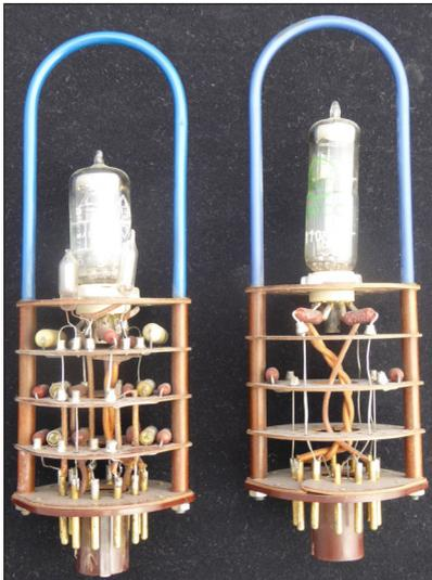
Abbildung 4-1: Zwei Basis-Schaltelemente der Z22 mit Vakuumröhren.
