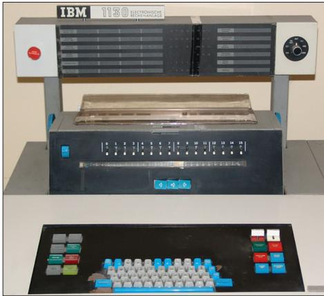
Abbildung 3-3: Steuerpult des Rechners IBM 1130 mit Tastatur, Schreibwerk und Anzeigeeinheit
